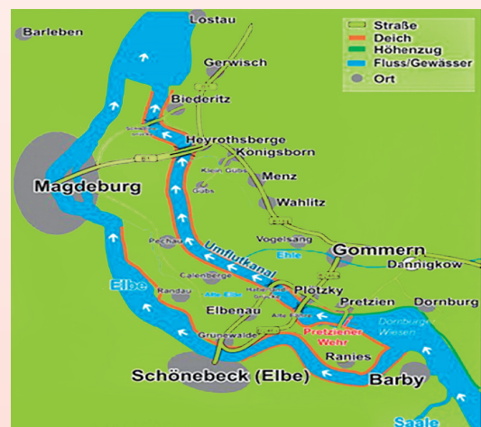
ภาพที่ 3 : แผนที่แสดงพื้นที่รับน้ำหรือแก้มลิงที่มีสมรรถนะในการกักเก็บน้ำต่างๆ กัน ในพื้นที่บางส่วนของแม่น้ำเอลเบในสหพันธ์สาธารณรัฐเยอรมนี
