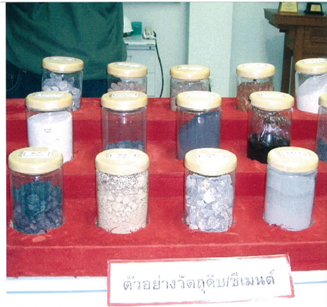
รูปที่ 3 ตัวอย่างวัตถุดิบในการผลิตปูนซีเมนต์จากธรรมชาติ วัตถุดิบทดแทน และผลิตภัณฑ์ซีเมนต์ Picture 3 : Examples of natural raw materials in cement production, substituted materials and cement products
