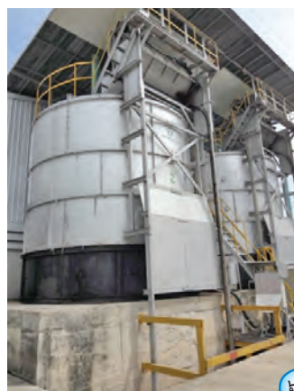
ภาพที่ ๖๓ - ๖๔ ระบบกำจัดของเสียที่เกิดจากมูลไก่ไข่เพื่อลดปัญหาสิ่งแวดล้อม ของบริษัท ฟาร์ม ชูสิน เตื่อนใจ ๙๙ จำกัด
