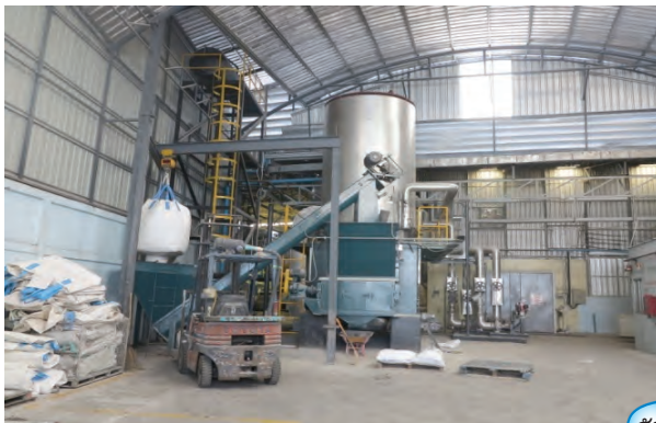
ภาพที่ ๕๓ - ๕๔ ระบบหม้อไอน้ำจากน้ำมันเตาเป็นเชื้อเพลิงชีวมวล (BIOMASS) ในการลดการปล่อยก๊าซมลพิษออกสู่สิ่งแวดล้อม ของบริษัทโรงแป้งพรกมล จำกัด
