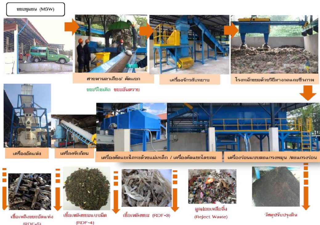
รูปที่ 3 ขั้นตอนการผลิตเชื้อเพลิงแข็งทดแทนโดยผ่านการแปรสภาพ
