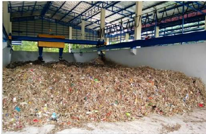
รูปที่ 2 ตัวอย่างการเทกลองขยะมูลฝอยสำหรับเตรียม RDF
