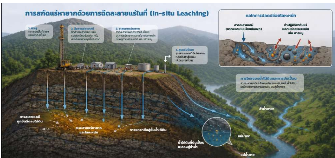
รูปที่ 2.3-6 เทคนิคการสกัดแร่หายากคือการฉีดละลายแร่ในที่ (In-situ Leaching)
